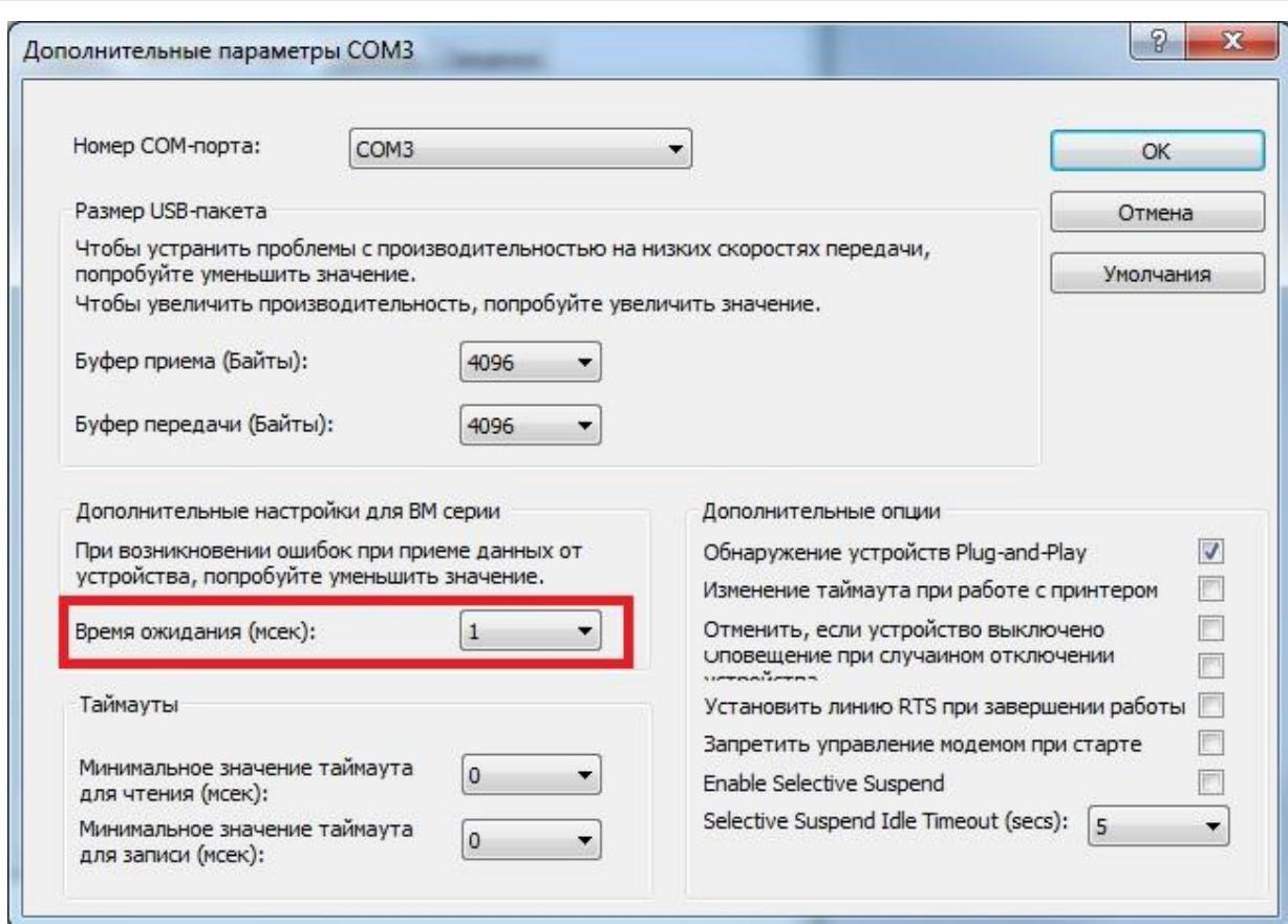
Рисунок 2.3. Окно дополнительных параметров последовательного порта
