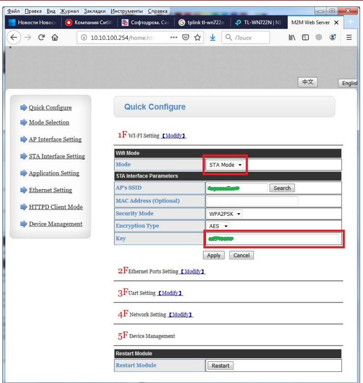
Рисунок 2.7. Настройки Wi-Fi преобразователя
