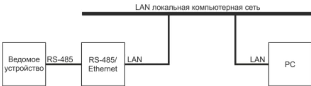
Рисунок 1.3. Схема подключения преобразователя RS-485 – Ethernet в локальную сеть
