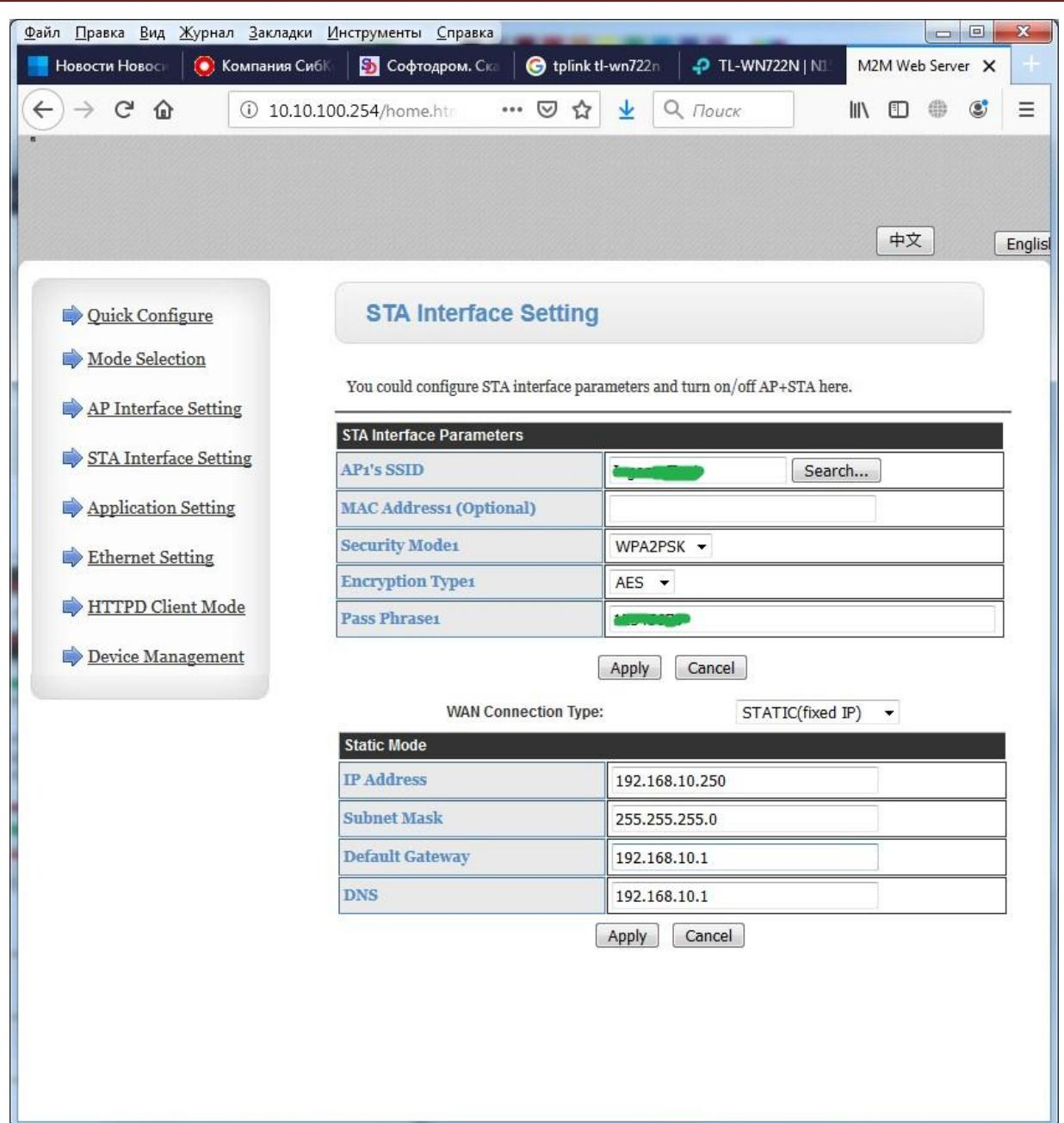
Рисунок 2.12. Настройки STA интерфейса преобразователя
