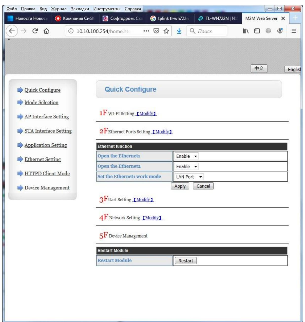
Рисунок 2.8. Настройки Ethernet порта преобразователя
