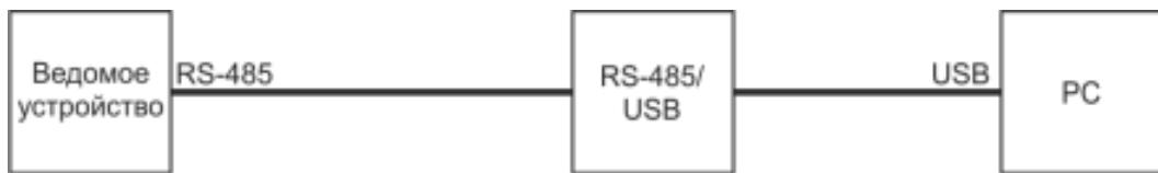
Рисунок 1.2. Схема подключения преобразователя RS-485 - USB
