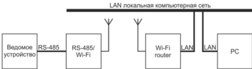
Рисунок 1.4. Схема подключения преобразователя RS-485 – Wi-Fi в локальную сеть
