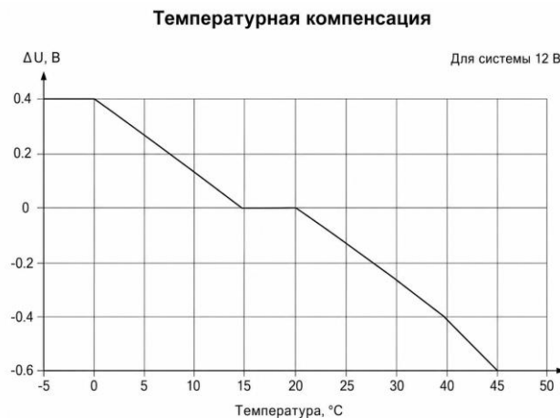
Рисунок 12 — График температурной компенсации для системы 12 В
